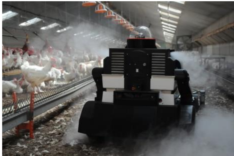
Robot Octopus Poultry Safe dans un bâtiment d'élevage de poulets (essai de pulvérisation d'un produit biocide sans danger pour l'animal)
