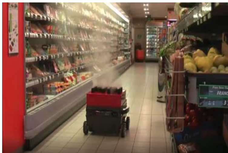
Robot Octopus Biosafety (robot V0) dans un supermarché (essai de pulvérisation d'un produit biocide dans un bâtiment recevant du public - ERP)
