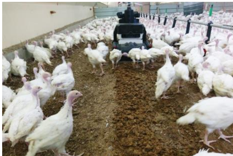
Robot Octopus Scarifier dans un bâtiment d'élevage de dindes (essai de scarification de la litière pour réduire le taux d'ammoniac et éviter la formation de croûtes à l'origine de pododermatites)
