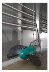
Source : Weltec Biopower (Agitateur axial – gauche / brasseur immergés - droite)
