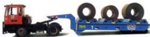
Rolltrailer 60T pour le transport de bobines Société Arcelor
