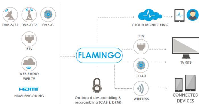
La tête de réseau Flamingo 3.9 permet dorénavant de diffuser les contenus sur tous types de réseau (IPTV, coaxial, wifi) afin de permettre la lecture sur tous les terminaux. Grâce au nouveau module de transcodage proposant les technologies d'adaptation du débit (ABR), la diffusion vers les appareils mobile est rendue possible.
