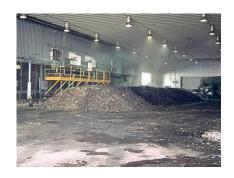
Un processus de combinaison des résidus assure des conditions propices au démarrage du procédé. Ce mélange est ensuite déposé sur le système de distribution d'air qui est configuré en fonction de la composition du mélange et d'une hauteur de compostage optimale. La ventilation est assurée par des ventilateurs à pression positive. Le système de base comprend un réseau de tuyaux perforés, disposés sous les andains à une hauteur et une largeur déterminées par les ingénieurs de Biomax.
