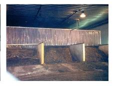
Un agitateur mécanique sur rail de conception exclusive est placé au dessus des murs et permet d'homogénéiser le matériel tout en le faisant progresser de l'entrée vers la sortie pendant une période de 18 à 21 jours.
