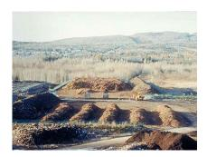
La masse à composter est déposée en tas plus ou moins importants (andains) et l'oxygénation est assurée par des retournements mécaniques. Les différents équipements vont dépendre de l'importance des andains (pelle mécanique et andaineuse).
