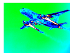
Signature infrarouge d'un avion
