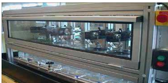
Source : CARMAT – bancs d'essais permettant de vérifier la fiabilité de la bioprothèse et de la pompe hydraulique
