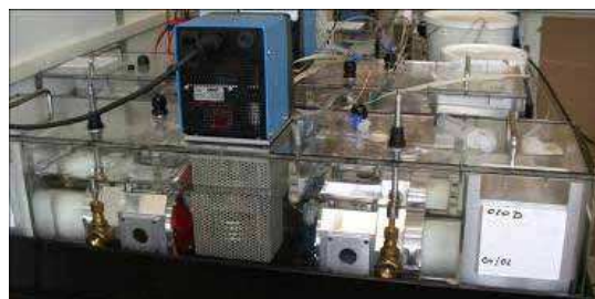
Source : CARMAT – bancs d'essais permettant de vérifier la fiabilité de la bioprothèse et de la pompe hydraulique
