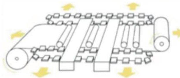
Schéma d'une ligne d'enduction avec mise en évidence de la mise sous tension
