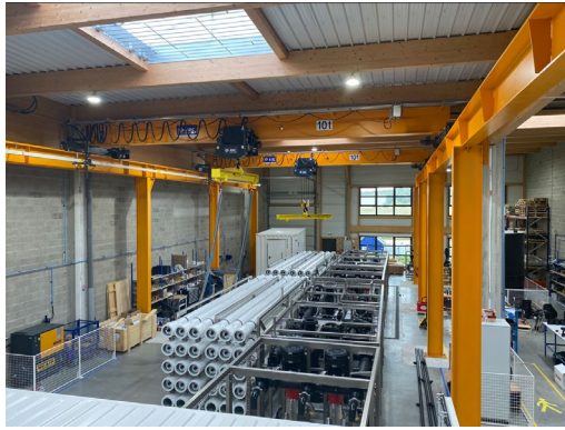
Fabrication dans les ateliers de production d'OSMOSUN de deux unités de 2.500 m 3 /jour
