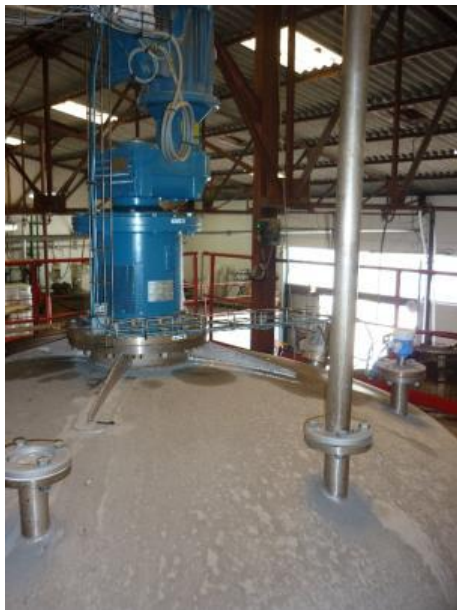
Mélangeur de 10 000 litres pour la fabrication de microémulsions
