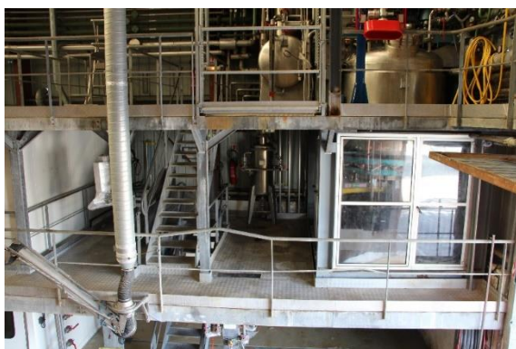
Filtre sécheur 3 000 litres inox (pression de travail : vide/pression atmosphérique) Traitement de 2000kg de végétal par semaine.
