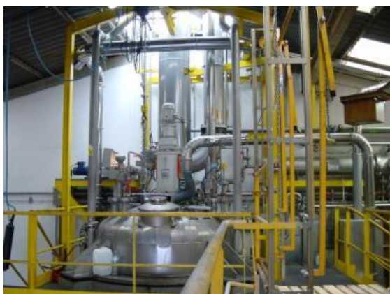
Réacteur de 10 m 3 pour la fabrication des résines en fusion
