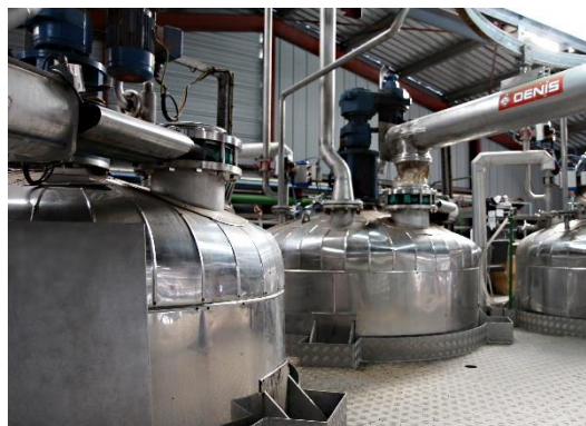
3 cuves de macération de 5 000 litres (chauffage vapeur) Caractéristiques : travail en semi-continu Rythme pour un extrait simple : 30 tonnes de végétal par semaine
