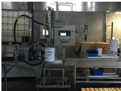
Conditionneuse semi-automatique (30 litres)
