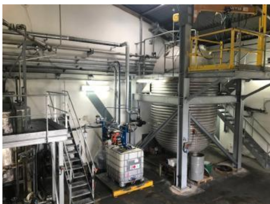
Réacteur de 10 m 3 pour la fabrication des résines en fusion
