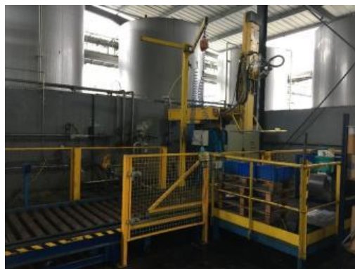
Conditionneuse semi-automatique (600 litres)
