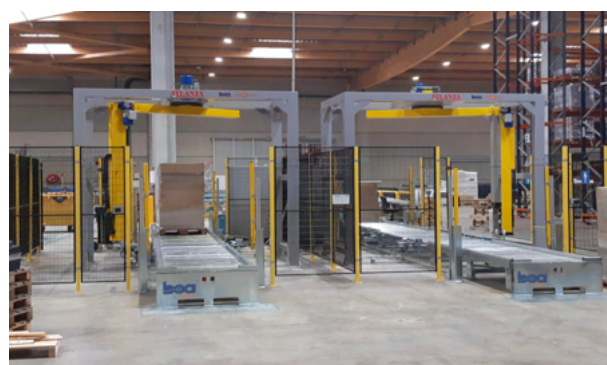
Fin de ligne palette avec filmage automatique
