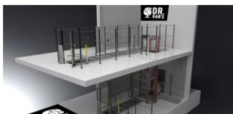
Ascenseur palettes avec convoyeurs HeavyLoad . Image de synthèse et réalité.
